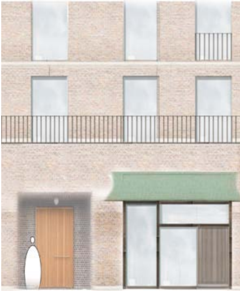
Markering av inngang ved bruk av farger/ materialskifte
